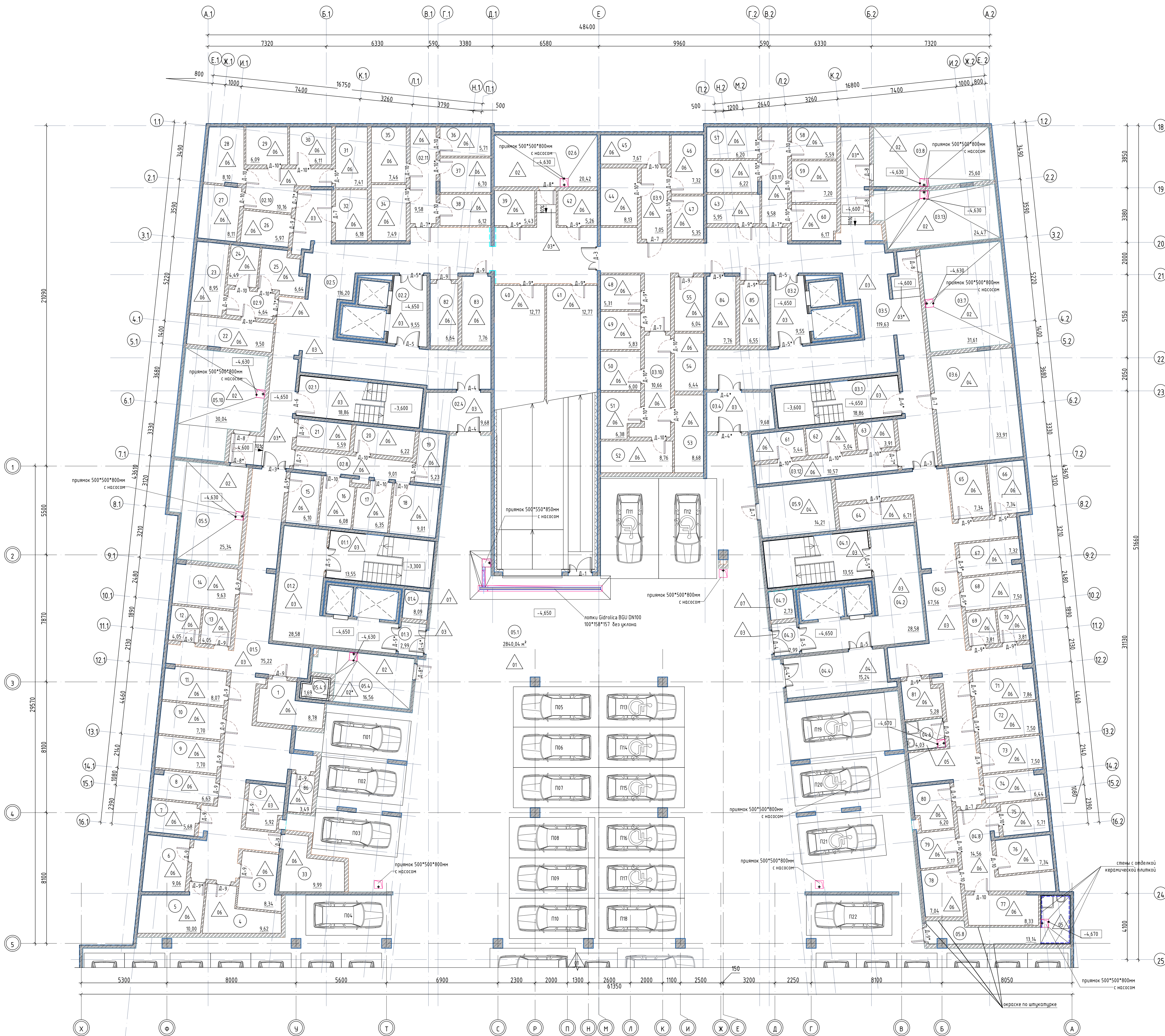
Отделочный план подземного этажа в осях 18-25/А.1-А.2 на отм -4.650. (1:100)
